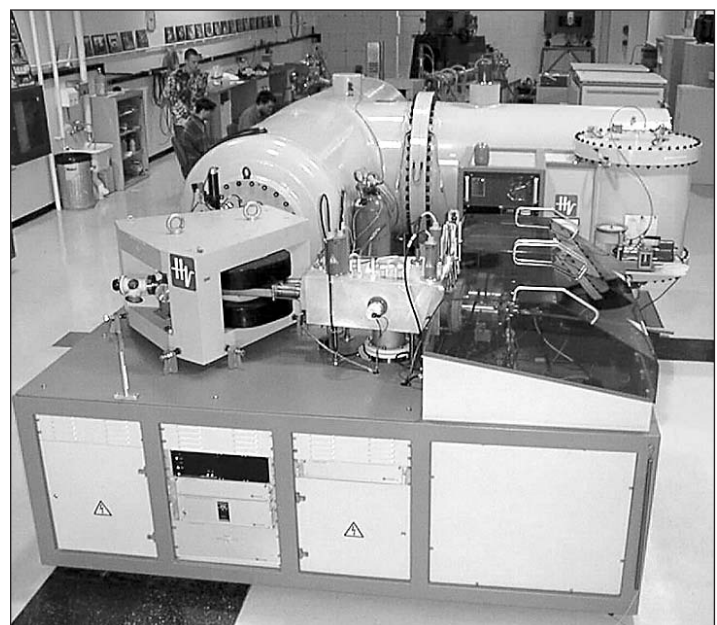
L'accélérateur Tandemron du Laboratoire de faisceaux d'ions de l'Université de Montréal; cet appareil peut créer une tension de 1,7 mégavolt.
